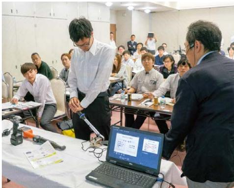
トルクテスタによるトルクレンチの締結実験。正しい位置で持ち、正しく力をかけないとオーバートルクに
