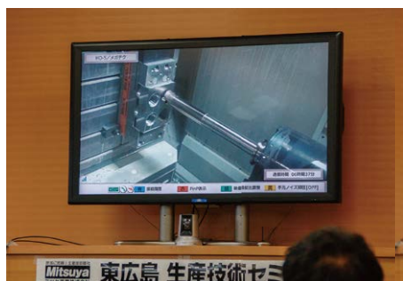
防振機構内蔵ホルダ・スマートダンパーでの切削実例。右側がスマートダンパーで加工した穴だが、ライブで映像を見ると、びびりを抑えて深くまできれいに加工できているのがひと目で分かる。
