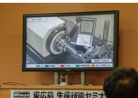
ハイドロチャックの振れ測定の実際をライブで見る。高精度で取付が出来ているのがわかる
