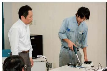
プリセット型トルクレンチを操作する場合、ラチェットで空転するからといって力任せに締め付けると、設定された値よりも数倍の締付トルクがかかってしまう。トルク管理には特性を考慮した機器選定も重要です
